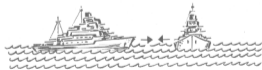
Rys. 44. Dwa wielkie krążowniki z odległości 100 m przyciągają się z siłą około 400 G
