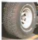
Rys. 4.12. Siła tarcia między oponą i podłożem nie zależy od tego, jak szeroka jest opona. Stosowanie szerokich opon ma na celu zwiększenie kontaktu z jezdnią i przez to zmniejszenie wydzielonego ciepła i ścierania się opon
