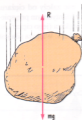
Rys. 4.15. Dopóki ciężar ciała mg jest większy od siły oporu powietrza R , dopóty ciało spada ruchem przyspieszonym. W miarę wzrostu prędkości, R również rośnie. Gdy R = mg , przyspieszenie znika i worek spada z prędkością graniczną
